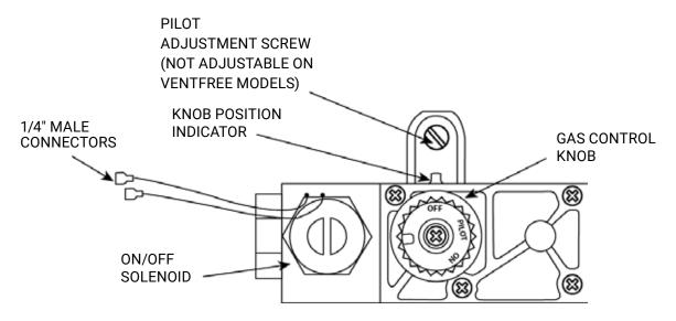
FACE VIEW OF GAS CONTROL WITH SOLENOID
